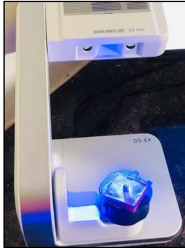
Fig. 6 a. CAD CAM digital scanner
